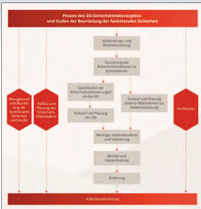
Bild 2: Ein FSM orientiert sich am Sicherheitslebenszyklus, wie er in der DIN EN 61511 definiert ist. (Bild: Rösberg)
