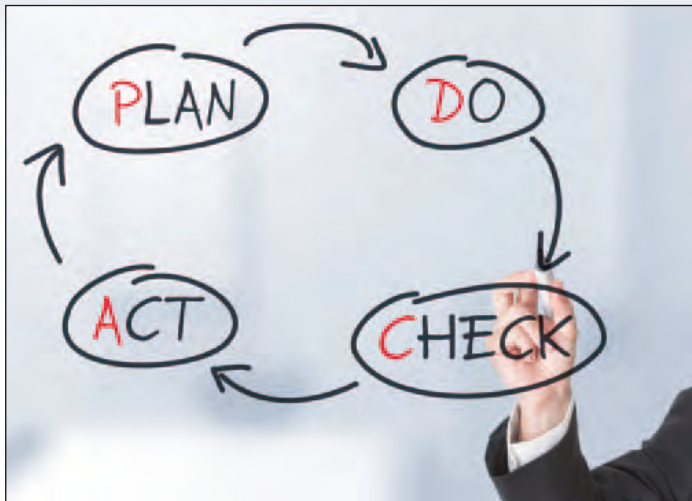
Bild 2: Die ISO 50001 basiert auf dem PDCA-Zyklus (Plan-Do-Check-Act, deutsch: Planung-Umsetzung-Überprüfung-Verbesserung). Sie legt einen Schwerpunkt auf kontinuierliche Verbesserungsprozesse (Quelle: Shutterstock)
